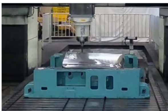
大型門型加工機による金型加工
